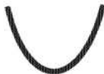
Схема А.4 – стальная V-образная вставка для соединения ПБЗГУ свариванием за закладные детали
